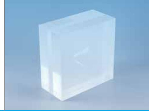
Der QUART DVT\_150 Prüfkörper dient der Sicherstellung der Bildqualität an Durchleuchtungsgeräten in der Humanmedizin, die mit einer 3D-Funktion ausgestattet sind. Mit dem Phantom können auch 3D-Röntgengeräte geprüft werden, die in der HNO eingesetzt werden.
